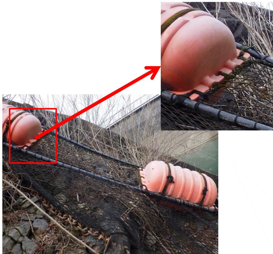
水位変動の大きいダムで法面と激しく擦れる条件下であったが、フロート本体に大きな損傷や結束ロープの脱落がなく、網場の機能を保持していることを確認した。
